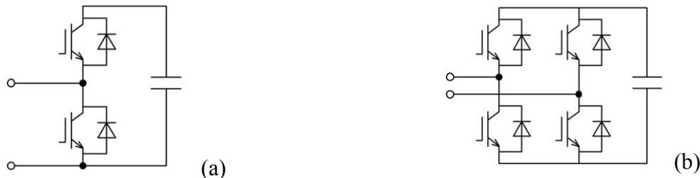
Fig. 5 : (a) Cellule à 1/2 pont, (b) Cellule en pont complet
